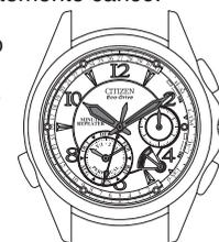
\* Una volta che l'orologio si è arrestato per carica insufficiente, anche se esso viene esposto alla luce, si richiede un minimo di circa 30 minuti per iniziare di nuovo a funzionare.
