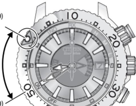
Per ragioni di sicurezza durante le immersioni la scala rotante unidirezionale può ruotare esclusivamente in senso antiorario (a sinistra).
