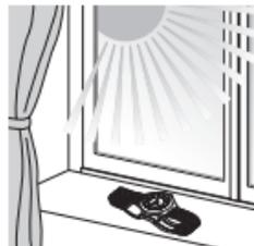
Se l'orologio non è esposto a una luce di sufficiente intensità, ad esempio quando è coperto da una manica lunga, la ricarica potrebbe risultare incompleta e non garantire così il normale funzionamento. Si raccomanda pertanto di lasciarlo esposto alla luce quanto basta affinché si ricarichi.
