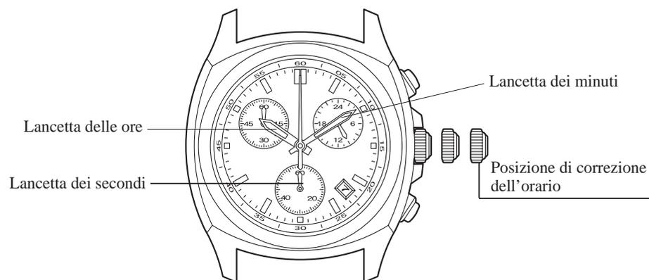
Se la corona è del tipo con bloccaggio a vite, prima di azionarla allentare la vite ruotando la corona a sinistra, e dopo aver riportato la corona alla posizione normale dopo averla azionata, riavvitare la vite in modo sicuro ruotando la corona a destra e premendola verso l'interno.
