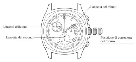
Se la corona è del tipo con bloccaggio a vite, prima di azionarla allentare la vite ruotando la corona a sinistra, e dopo aver riportato la corona alla posizione normale dopo averla azionata, riavvitare la vite in modo sicuro ruotando la corona a destra e premendola verso l'interno.
