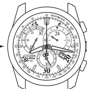
Quando si carica l'orologio esponendo la cella solare alla luce, la lancetta dei secondi riprende il movimento ad intervalli di 2 secondi. Tuttavia, poiché l'orologio si è fermato a causa di carica insufficiente, l'orario indicato non è esatto. Caricare sufficientemente l'orologio finché la lancetta dei secondi riprende a muoversi ad intervalli di 1 secondo, e quindi reimpostare l'orario prima dell'uso.
